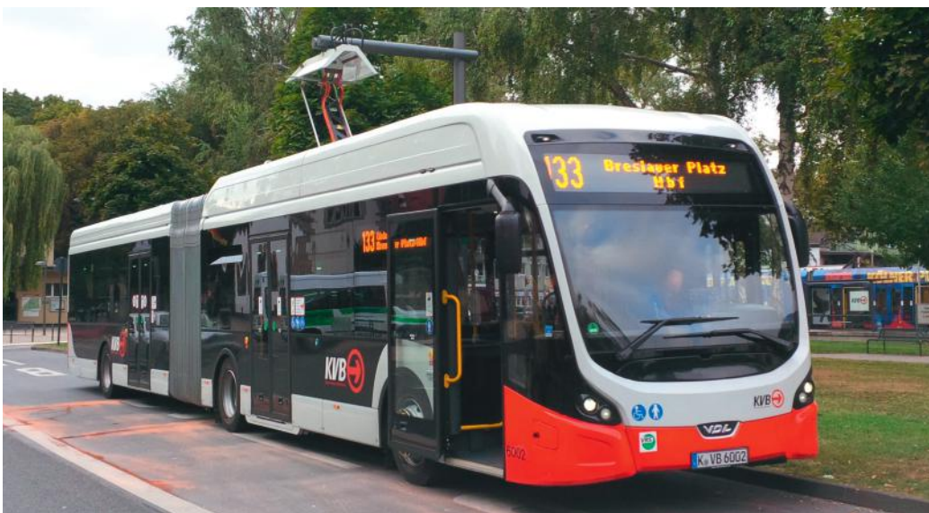
Beispiel für Batteriebus als Teillader mit Pantograf
